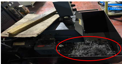
[그림 1] 실제 CNC 선반에서 발생하는 연속형 칩
