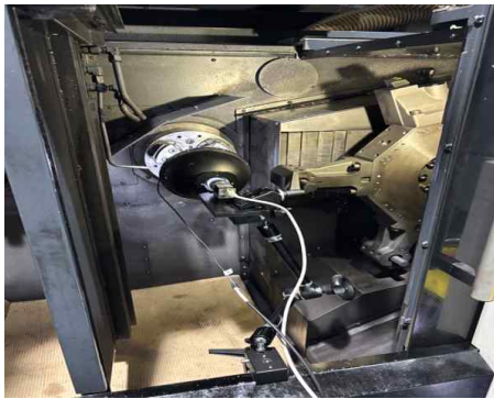
[그림 3] 비전센서 및 조명 설치
